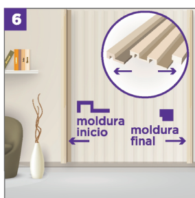
6 Instalación de molduras.
