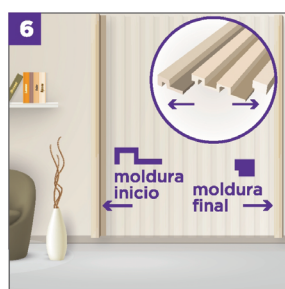
6 Instalación de molduras.
