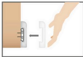
7. Presione el guardaescoba sobre los clips de fijación hasta que quede firme.
