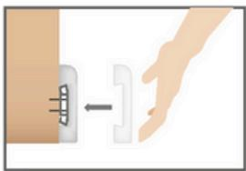
7. Presione el guardaesoba sobre los clips de fijación hasta que quede firme.
