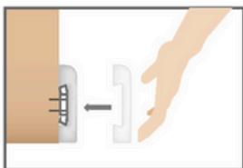
7. Presione el zócalo sobre los clips de fijación hasta que quede firme.
