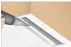
Aplica abundante adhesivo PRO-FIX, silicona neutra o cemento de contacto sin solvente) en la parte posterior del zócalo/contramarco
